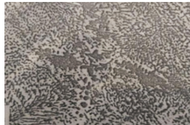
Şəkil 6 və 7. Mis ərintinin mikrostrukturunu 0.39% O 2 . Mis ərintinin mikrostrukturunu O 2 - 0.39%-dən çox.
